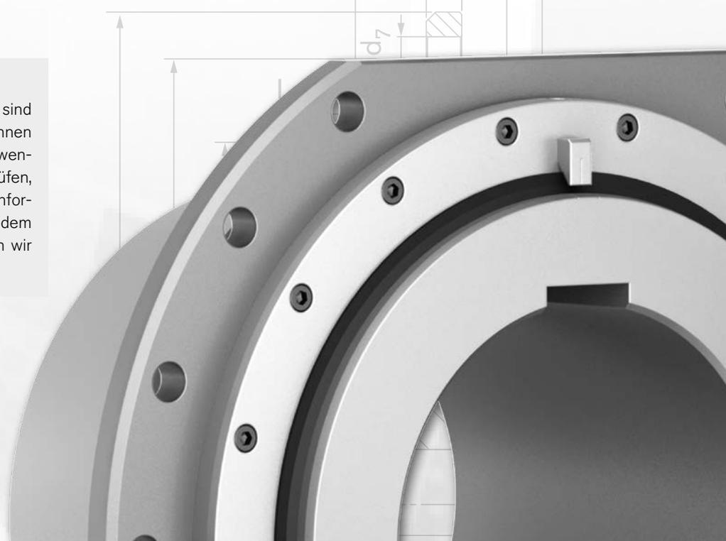
Üblicherweise verfügen die Tonnen in der Kupplung über einen axialen Freiraum, so dass axiale Bewegungen zwischen Seiltrommel und Getriebe ausgeglichen werden. Bei einer derartigen Konstruktion funktioniert das Gelenk wie ein Loslager. Die Tonnen werden axial durch Sicherungsringe auf der Nabe fixiert. Bei der SEB-Ausführung verbessern zusätzliche Druckringe die axiale Sicherung der Tonnen. Im Einzelfall hat die Tonnenkupplung wie ein Festlager zu funktionieren,
